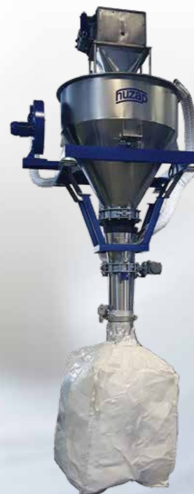
Automatische elektronische Nettoschüttwaage mit 2-Wege Entleerung Electronic net weighing scale with 2-way discharge Elektroniczna waga netto z dwukierunkowym opróżnianiem Электронные весы нетто с опорожнением по двум направлениям
